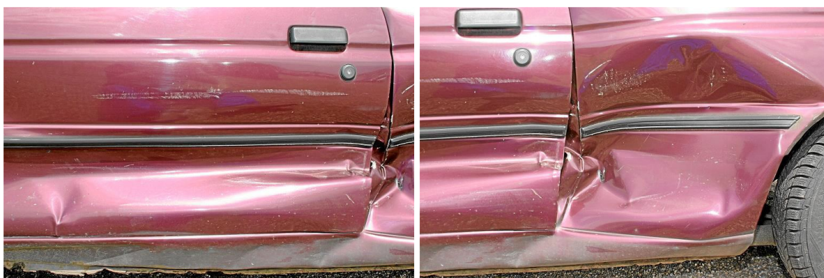
Слика бр. 45 – Карактеристике оштећења бочне стране покретног возила
