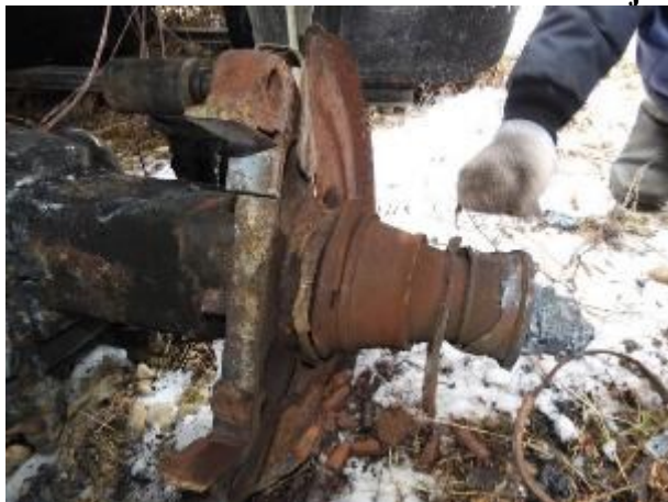
Ft. 26 Osovina točka z.l. sa ostacima ležaja
