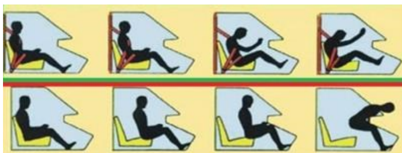
Slika 4: Faze kretanja vozača /suvozača pri čeono-bočnim sudarima sa i bez sigurnosnog pojasa
