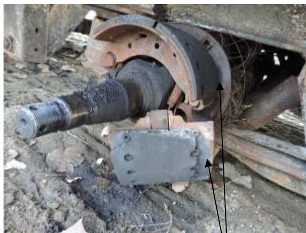
Ft.14 Nedostajući deo ferode na donjoj i gornjoj polovini pakni (deo bliži „S“ ključu)
