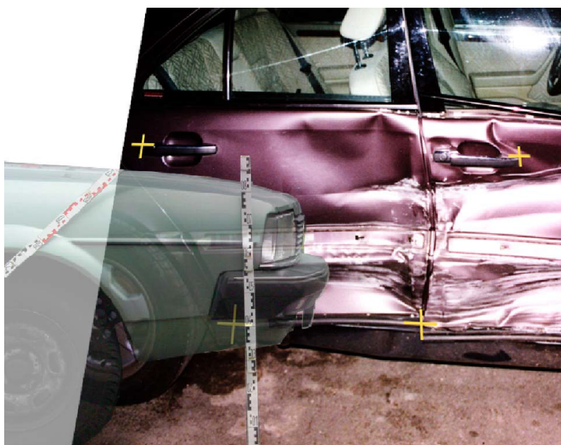
Слика бр. 10 - Прекривање обриса возила - бочна страна мерцедеса је претходно исправљена у бочној пројекцији ректификацијом фотографије
