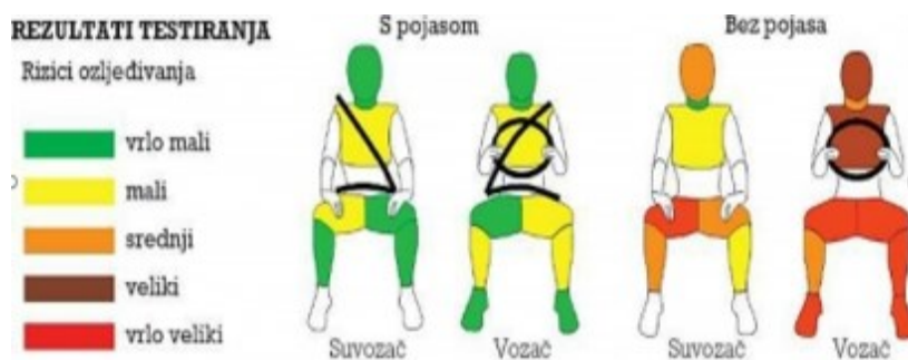
Slika 6: Rizik povređivanja kod vozača i suvozača pri i bez upotrebe sigurnosnog pojasa
