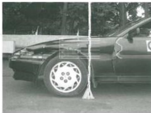
Слика бр. 35 - Оштећење на боку аутомобила контакта са вертикално уграђеним штитником профила А
