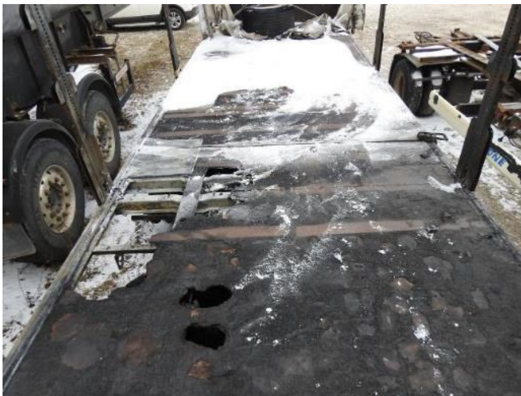
Ft.3 Pod prikolice sa jasno vidljivim mestima progorevanja koje ukazuju na mesto početka širenja požara
