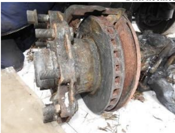
Ft. 22 Disk točka z.l. Opis oštećenja: Disk je po celom obimu termički oštećen. Izmerena debljina diska 41mm.
