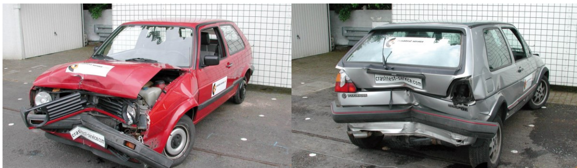
Слика бр. 16 – Референтни примери за одређивање вредности EES: за ударни ГОЛФ - EES 26,6 km/h, за ударени ГОЛФ - EES 25,2 km/h
