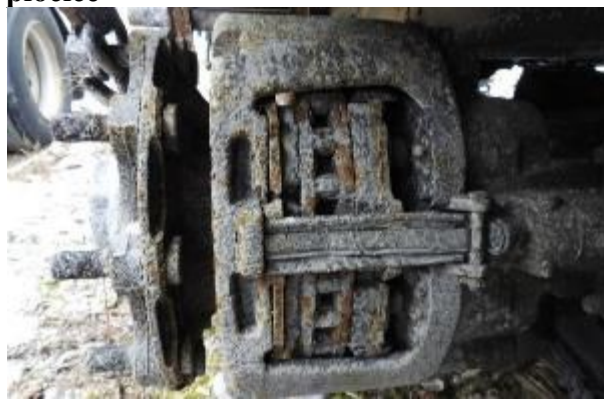
Ft. 25 Kočione pločice točka z.d. Opis oštećenja: Kočione pločice se nalaze na mestu i termički su oštećene. Debljina pločica je 18mm što ukazuje da su pločice menjane u skorije vreme.
