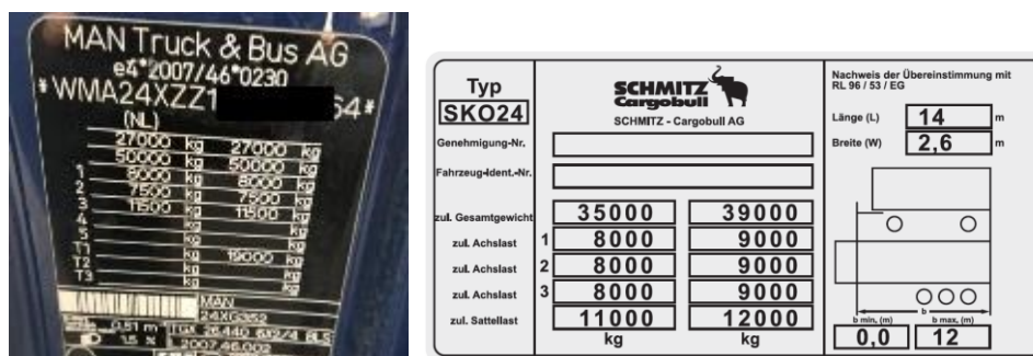
Slika 3. Primeri identifikacionih pločica troosovinskog teretnog vozila (levo) i poluprikolice - hladnjače (desno[12]). Na desnoj strani su tehnički dozvoljene vrednosti
