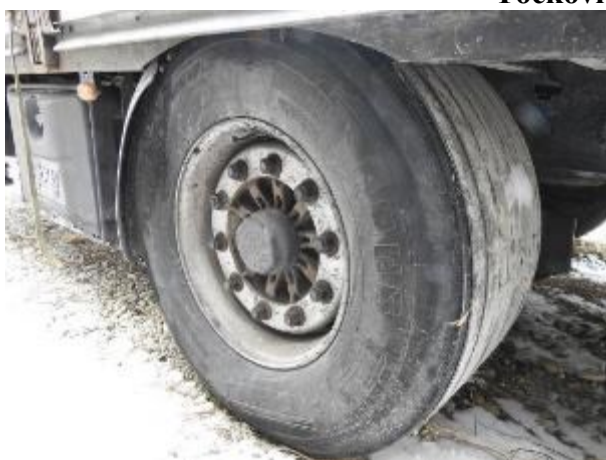
Ft. 18 Točak prednje osovine Opis oštećenja: Pneumatik je oštećen po celom obimu usled delovanja vatre. Izmerena dubina šare iznosi 6mm.
