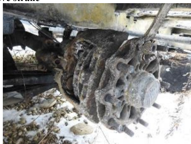
Ft. 19 Glavčina točka zadnje osovine Opis oštećenja: Naplatak točka i pneumatik nisu zatečeni na mestu pregleda. Naplatci zadnje osovine su demontirani zbog transporta sa lica mesta.
