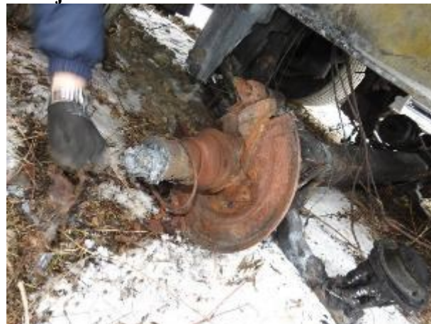
Ft. 27 Osovina točka z.l. sa ostacima ležaja
