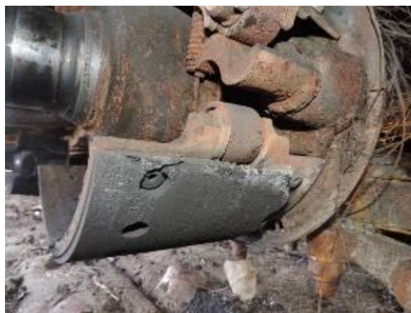
Ft.13 Tipičan izgled ferode p.d točka i izgled mehanizma kočnice sa jasno vidljivim znacima pregorevanja.
