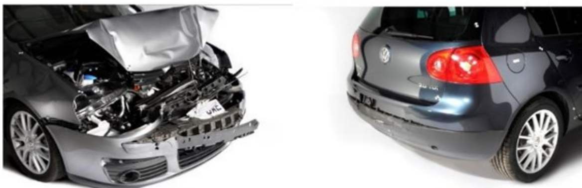
Слика бр. 7 – Судар испод браника \Delta V 16,0 km/h
