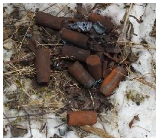
Ft. 29 Konusni valjci ležaja i tragovi sagorevanja masti
