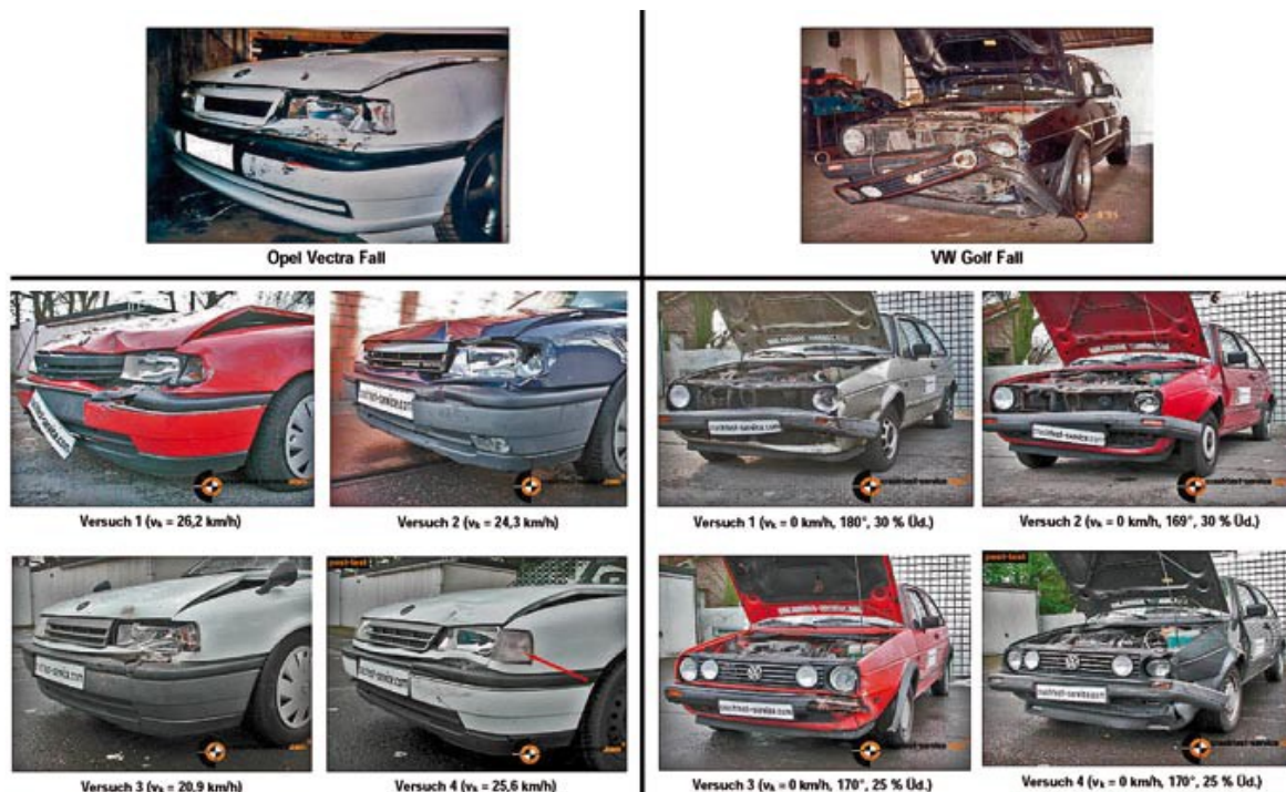
Слика бр. 13 - Анализа настанка оштећења на основу тестова (горе предметна незгода, доле тест)
