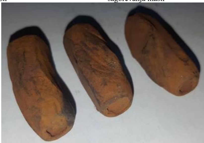
Ft. 30 Konusni valjci ležaja sa vidljivim tragovima plastičnih deformacija
