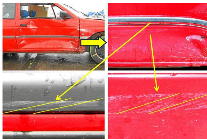
Слика бр. 48 – Карактеристике оштећења на удареном возилу
