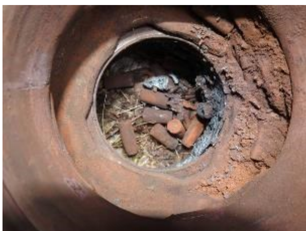
Ft. 28 Konusni valjci ležaja i tragovi sagorevanja masti
