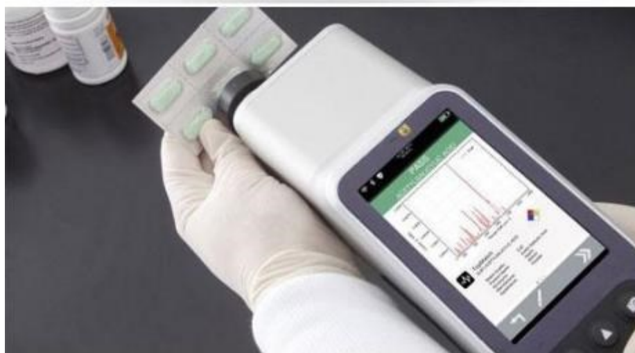
F8. Prenosivi ramanski spektrometar
